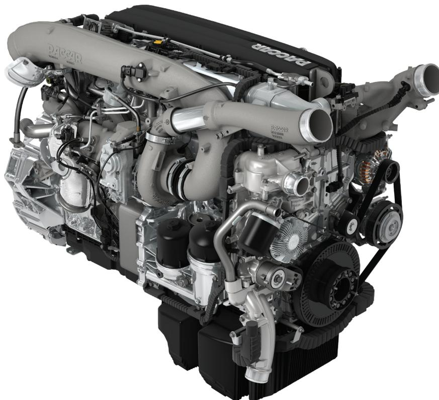
El motor MX-13 Euro 6 de 12,9 litros de PACCAR cuenta con una tecnología common rail ultramoderna, un turbo con geometría variable y controles avanzados para proporcionar la máxima eficiencia. Con el fin de cumplir los estrictos requisitos sobre emisiones de la norma Euro 6, cuenta con un sistema de recirculación de los gases de escape, además de la tecnología SCR y un filtro de partículas de hollín activo.
