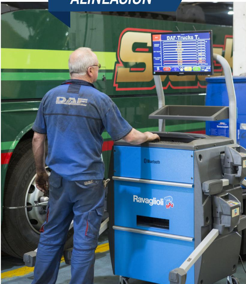
En nuestros talleres, contamos con potente maquinaria para diagnosticar y corregir la alineación de las ruedas con el fin de reducir el consumo de combustible y los costes derivados del desgaste de los neumáticos.
